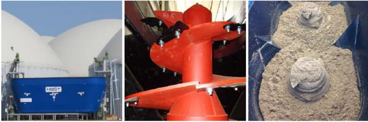
Rys. 4a. System dozowania sypkich substratów.
